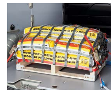
Gecombineerde ladingbeveiliging met ladingbeveiligingsnet en dwarsdragers
