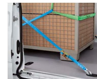
Vastzetten bovenkant van de lading met een rondstrop
